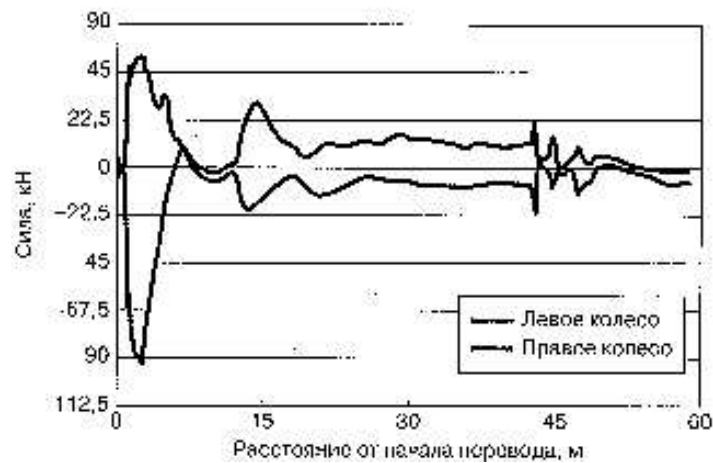
Рисунок 3 - Силы взаимодействия между колесами вагона и рельсами при прохождении стрелочного перевода № 20, не прошедшего модернизацию
