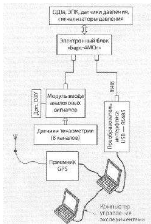
Рисунок 4 - Блок-схема измерительного комплекса для определения коэффициента сцепления колес с рельсами
