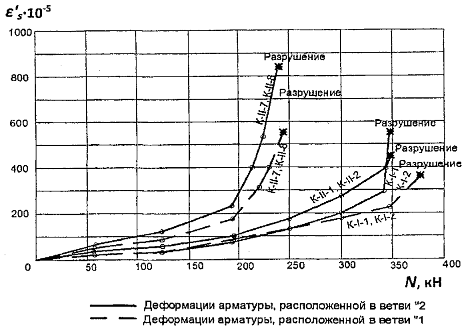
Рис. 11. Развитие деформаций \varepsilon' в наиболее сжатой арматуре опытных образцов
