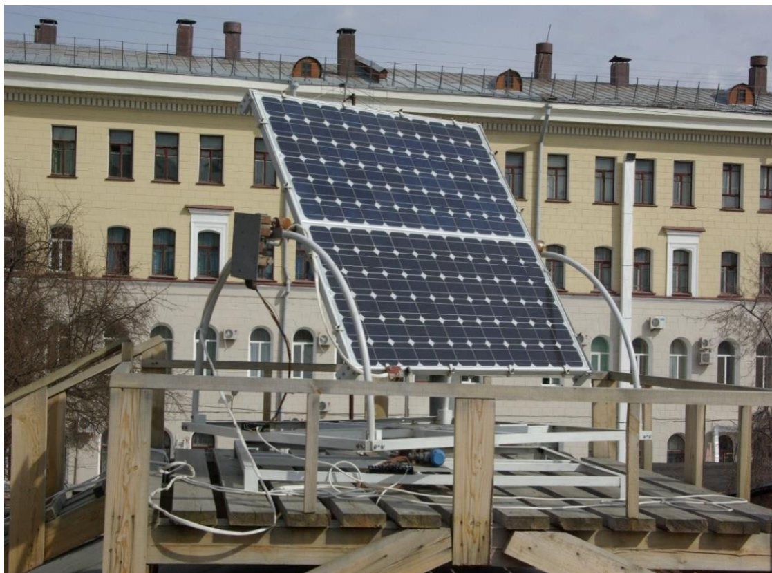
Рис. 2. Электромеханическая часть энергетической установки АФЭУ-0,5 с двумя фотоэлектрическими панелями КСМ-160
