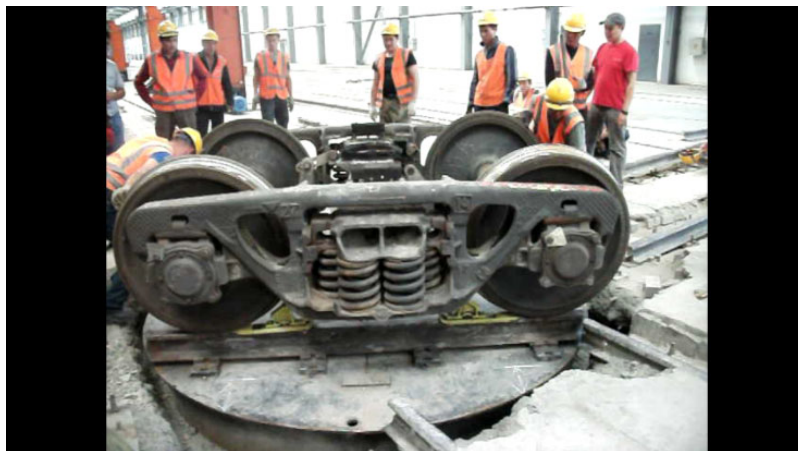
Рис.12. Поворот тележки на круге
