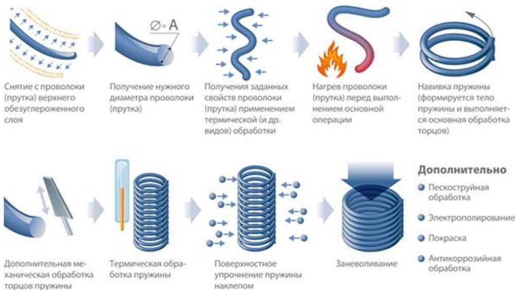
Рисунок 1. Алгоритм технологии производства сверхпрочных пружин для подвижного состава (ПС) и путевых машин (ПМ).
