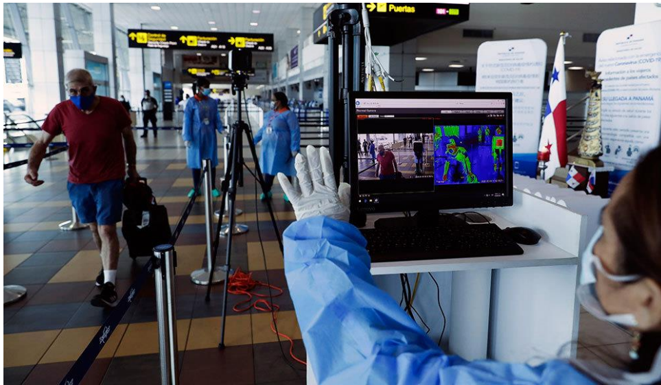
Рис.6. Проверка авиапассажиров на тепловизоре
