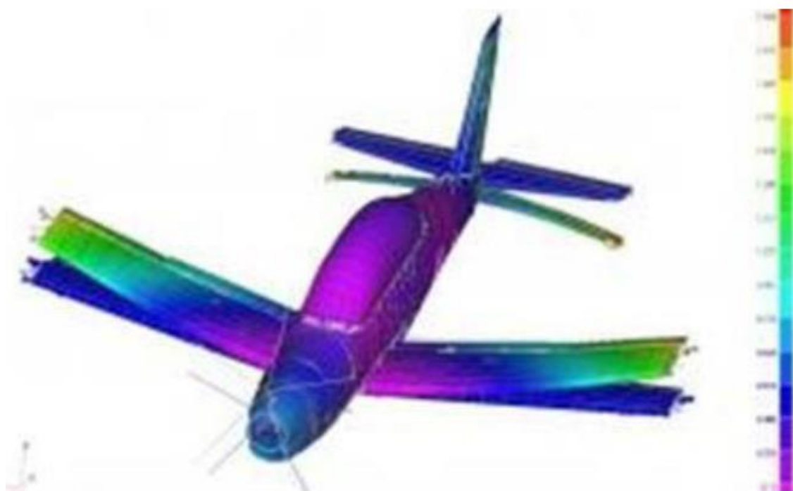
Рисунок 4 – Проекция нагрузки самолета в MSC
