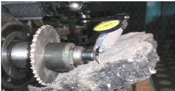
Рисунок 1. Процедура замера деформаций образца асфальтобетонного покрытия с помощью универсальной магнитной измерительной головки.
