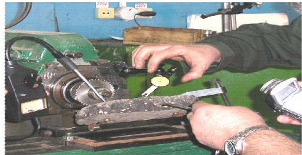
Рисунок 2. Измерение виброакустических колебаний в процессе резания с помощью виброизмерительной системы (США)
