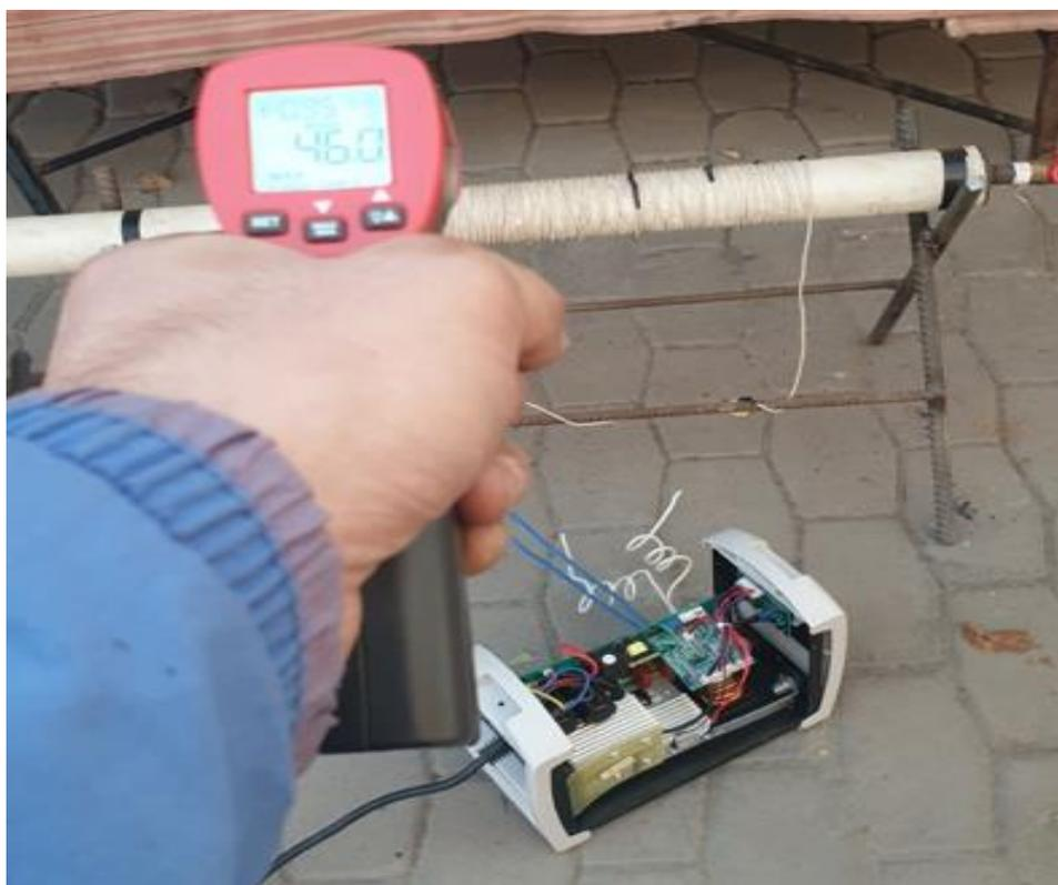
Рисунок 18 – Процесс обогрева трубы
