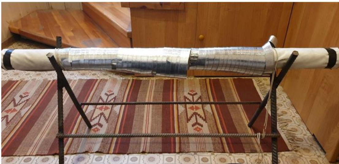
Рисунок 16 – Экспериментальная установка бифилярным методом намотки провода с использованием жести толщиной 0,5 мм
