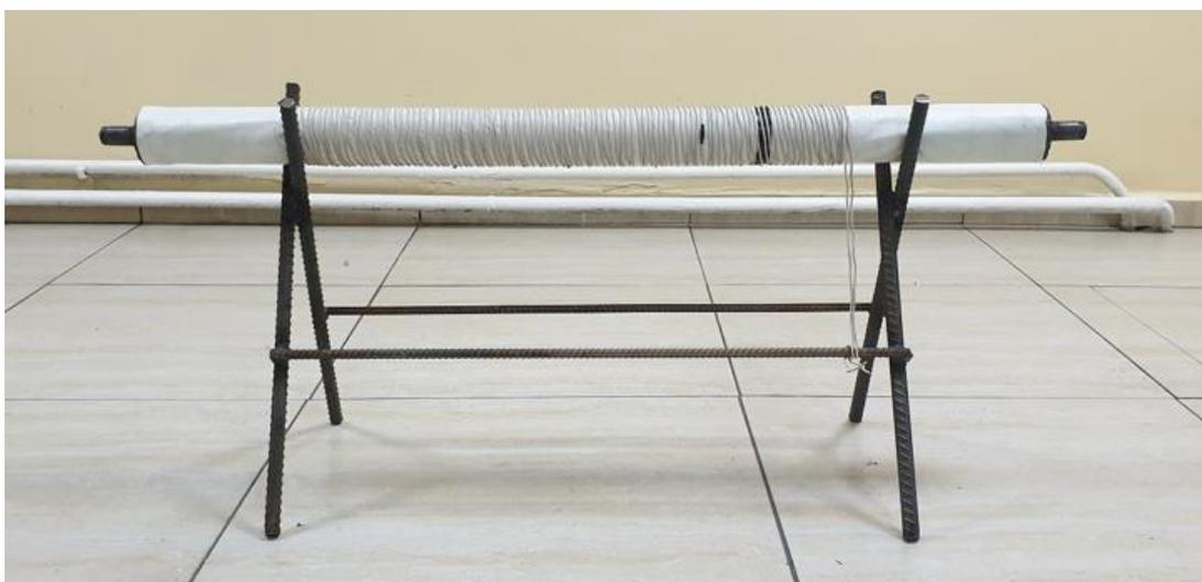
Рисунок 15 – Экспериментальная установка бифилярным методом намотки провода
