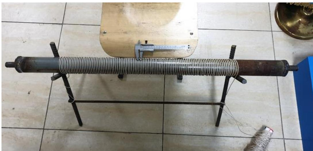
Рисунок 13 – Расстояние между витками 4 мм
