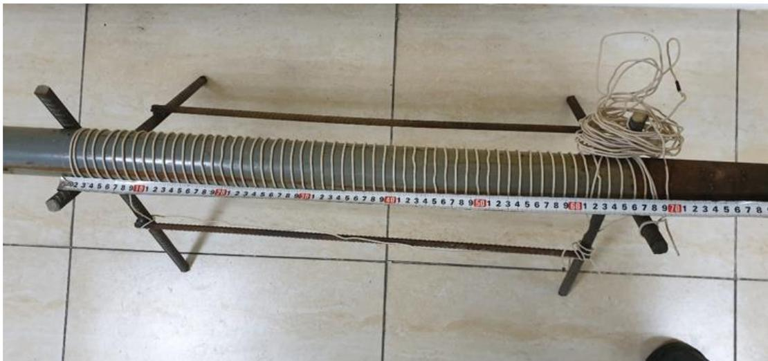
Рисунок 12 – Нагреваемый участок
