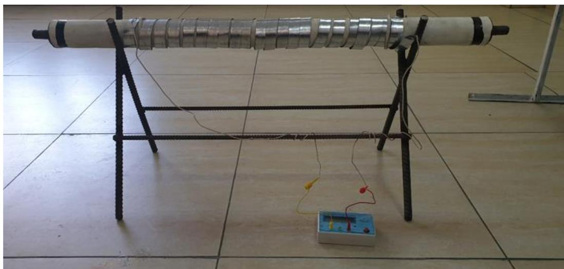
Рисунок 17 – Способ установки пластины шириной 2,5 см на трубу
