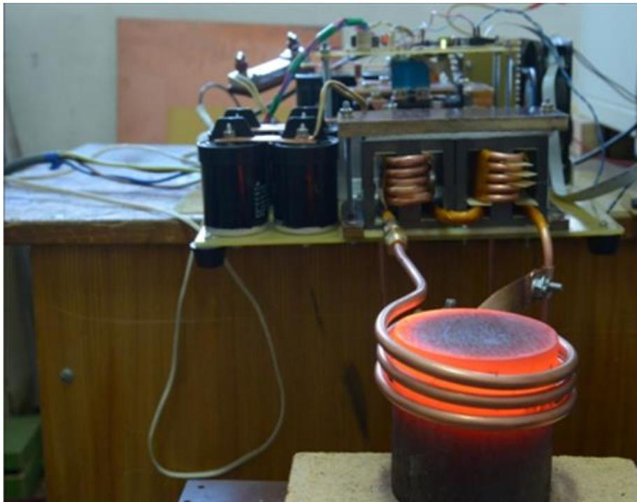
Рисунок 5 – Процесс индукционного поверхностного нагрева металла диаметром 120 мм при частоте 20 кГц
