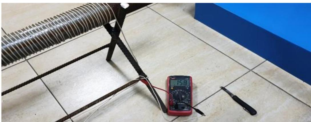
Рисунок 14 – Показания RLC измерителя при 4 мм
