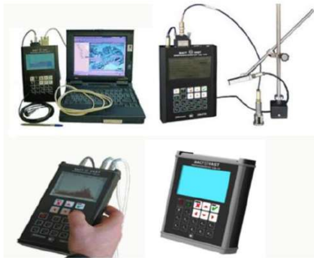
Сурет 3 – Т.ж. көлігінде тораптардың жай-күйін диагностикалау үшін дірілталдағыштар
