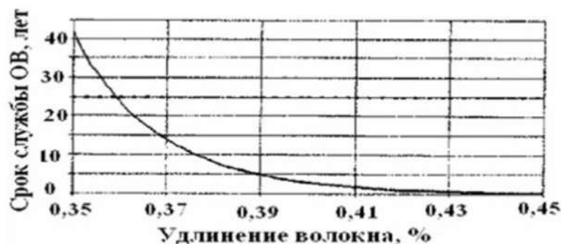
Рисунок 8 – Зависимость срока службы ОВ от продольной механической нагрузки
