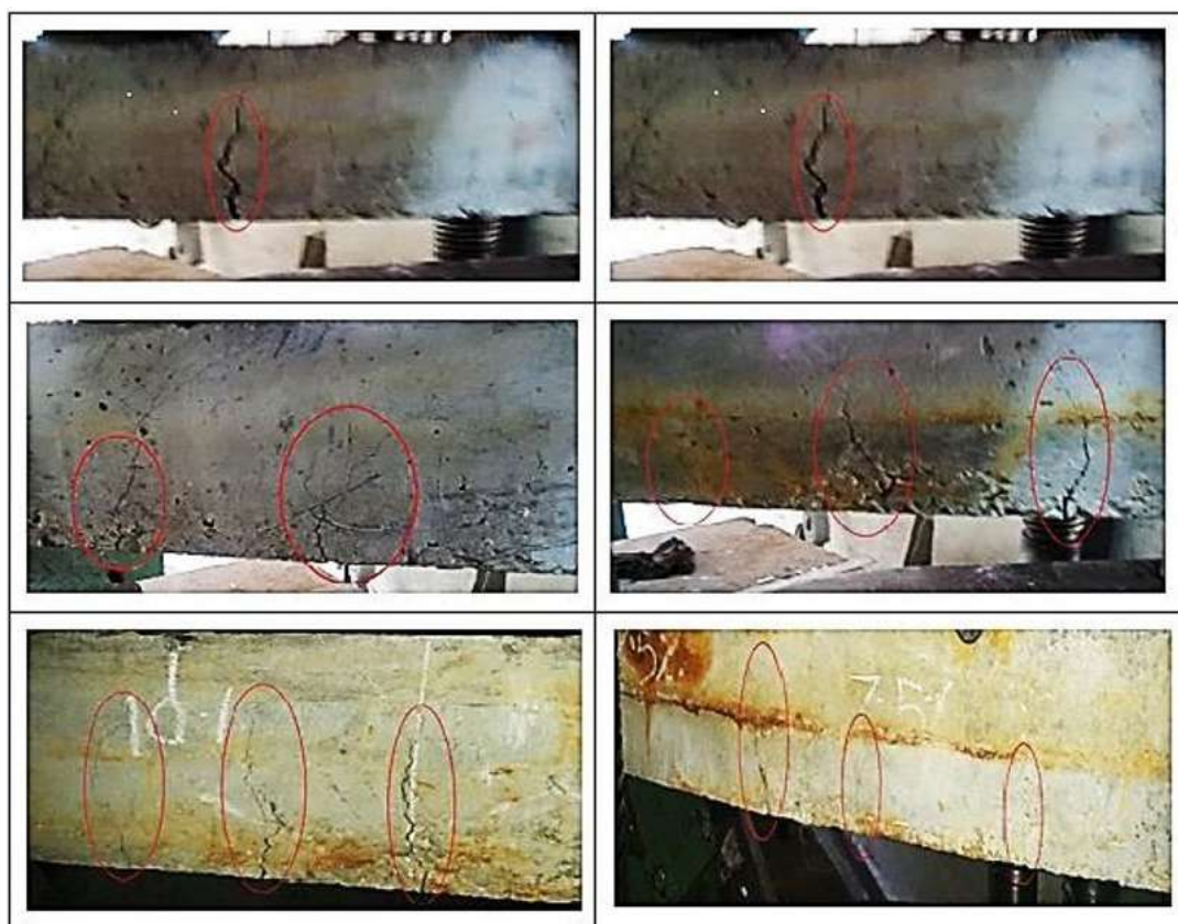
Рисунок 4 – Трещины при изгибе после испытания
