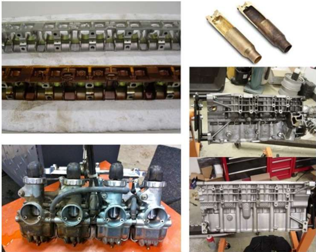
Рисунок 1 – Состояние деталей и механизмов до и после ультразвуковой очистки
