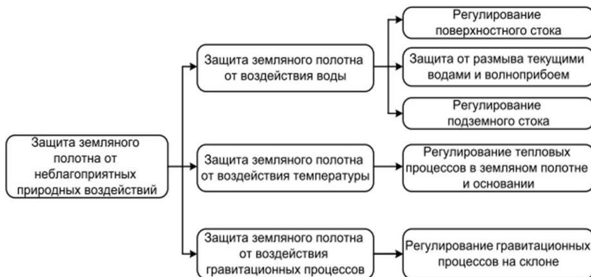
Рисунок 1 – Защита земляного полотна от неблагоприятных природных воздействий
