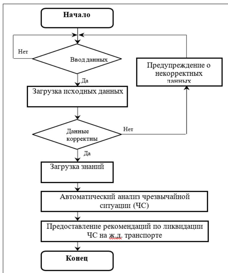
Рисунок 2 – Схема алгоритма работы интеллектуальной системы анализа ЧС на ЖДТ и рекомендации руководителям по ликвидации их последствий
