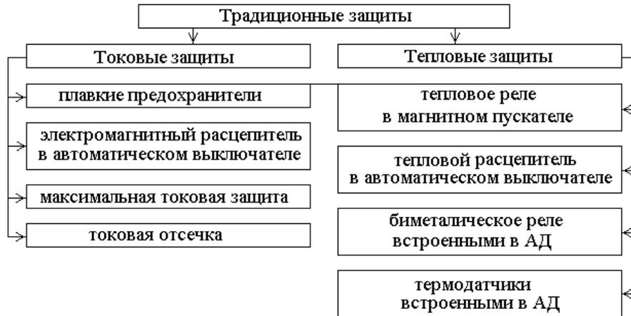
Рисунок 1 – Традиционные защиты асинхронного двигателя
