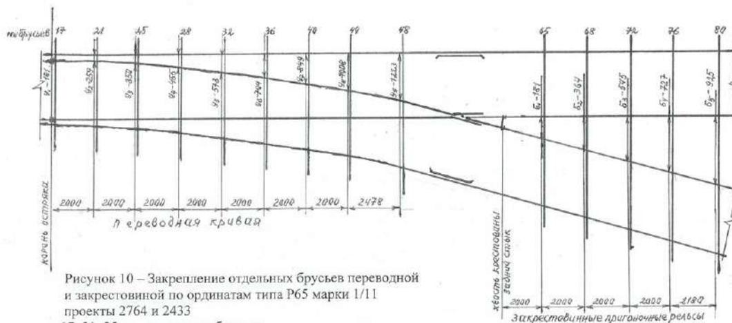
Рисунок 10 – Закрепление отдельных брусьев переводной и закрепленной по ординатам типа Р65 марки 1/11 проекты 2764 и 2433
