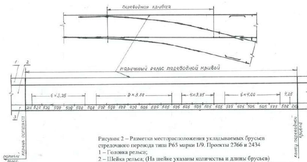
Рисунок 2 – Разметка месторасположения укладываемых брусков стрелочного перевода типа Р65 марки 1/9. Проекты 2766 и 2434
