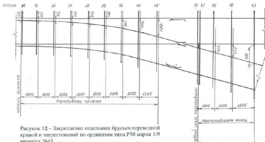
Рисунок 12 – Закрепление отдельных брусьев переводной кривой и закрестовиной по ординатам типа Р50 марки 1/9 проекты 2643
