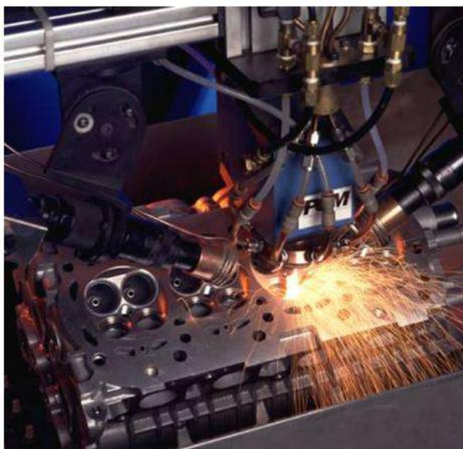
Рисунок 3 – Нанесение износостойкого покрытия на седла клапанов ДВС
