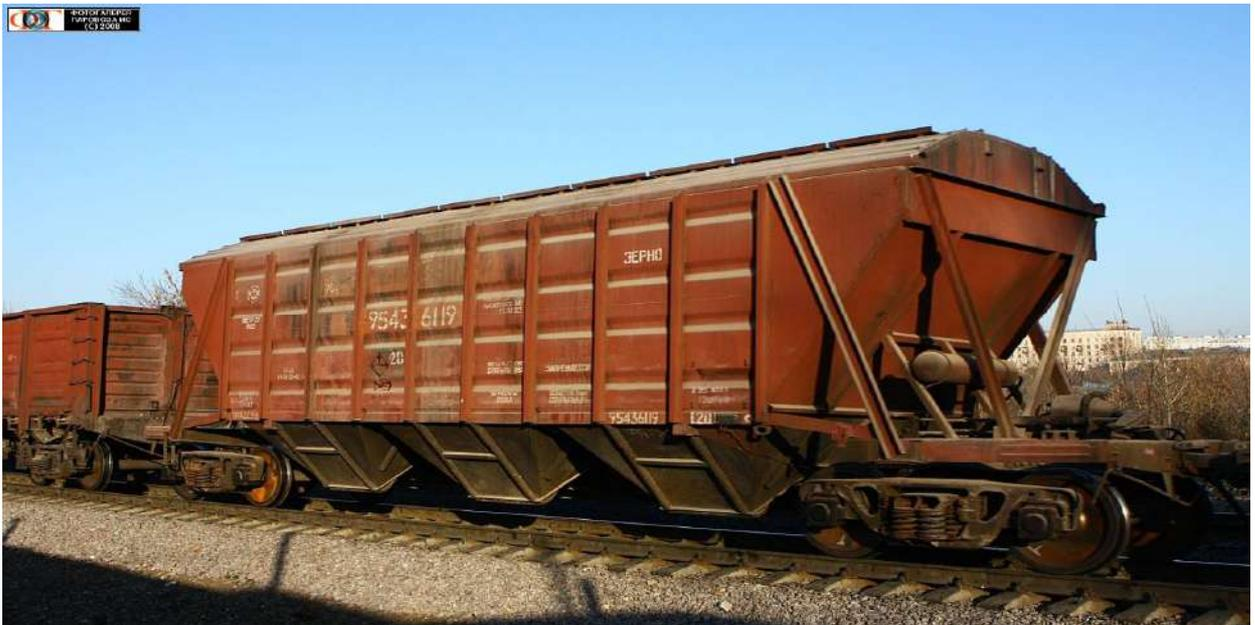
Рисунок 1 – Вагон для перевозки зерна (хоппер)
