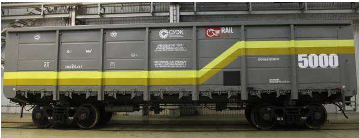
Рисунок 1 – Полувагон универсальный с разгрузочными люками, модель 12-9853 с осевой нагрузкой 25 тс
