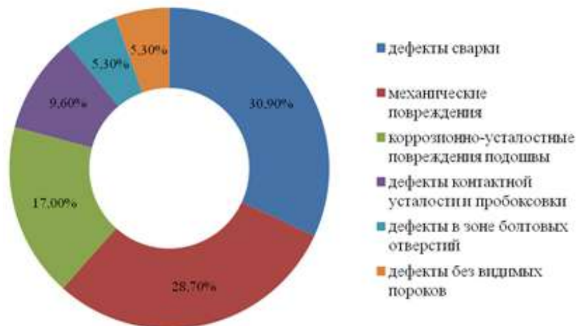
Рисунок 2 – Причины изломов рельсов в 2016 г.
