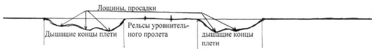
Рисунок 9 – Состояние «дышащих» концов рельсошпальной решетки со скреплениями «Фоссло», ЖБР, КПП-5
