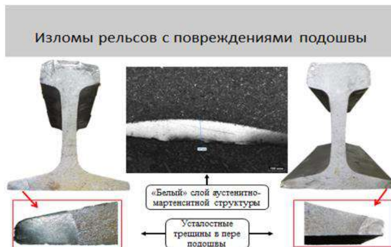
Рисунок 4 – Характерные виды повреждений подошвы рельса
