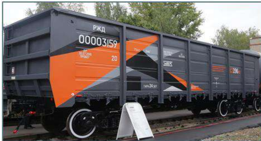
Рисунок 3 – Полувагон модели 12-196-02 с увеличенным объемом кузова АО «НПК «Уралвагонзавод»
