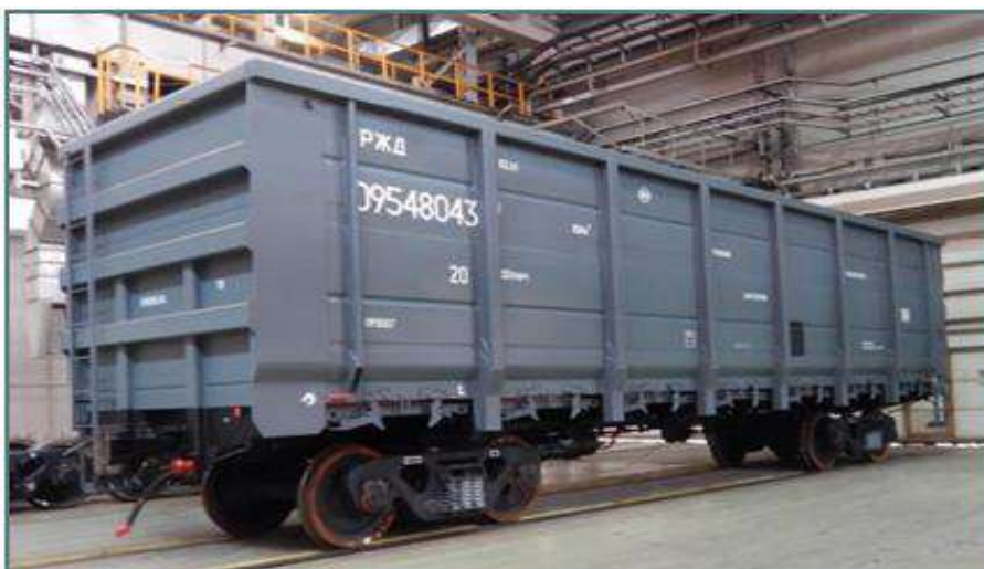
Рисунок 2 – Универсальный полувагон с осевой нагрузкой 27 тс, модель 12-9548
