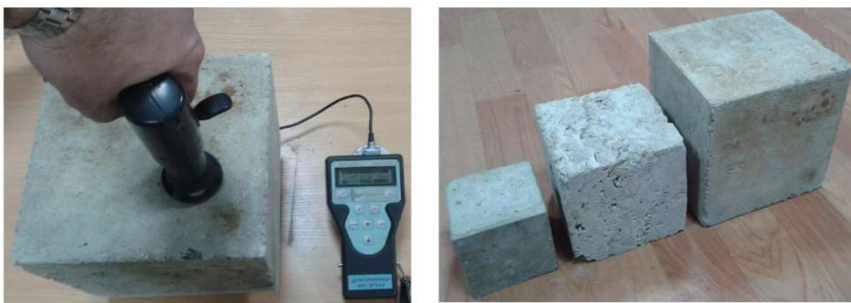
Рисунок 1 – ИПС МГ4.03 в рабочем состоянии (а) и образцы (кубики) партий №1, №2, №3 (б)
