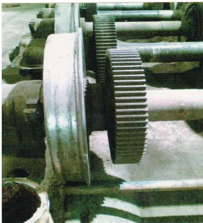
Рисунок 1 – Износ бандажа колесной пары
