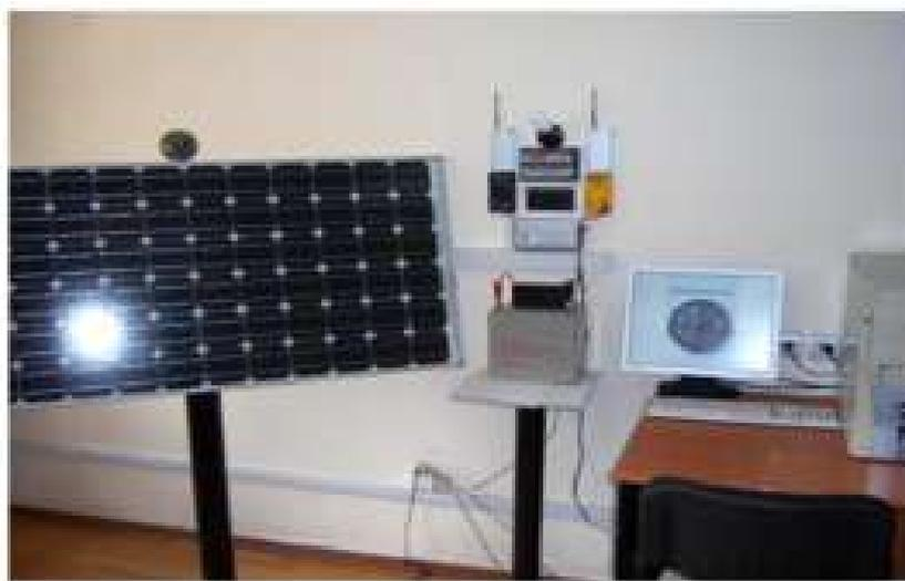
Рисунок 3 – Опытный образец гелиоустановки с системой наведения разработанной в АУЭС
