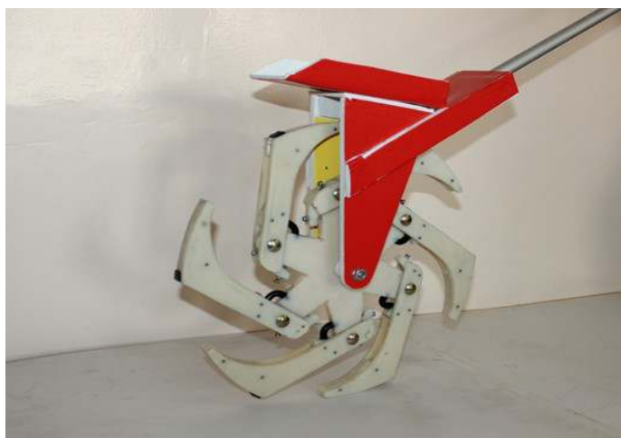
Рисунок 5 – Фотография макета универсального шагающего колеса
