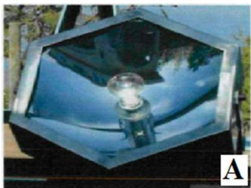
Рисунок 1 – Модули на основе системы Кассегрена – А и фасетными концентраторами – Б
