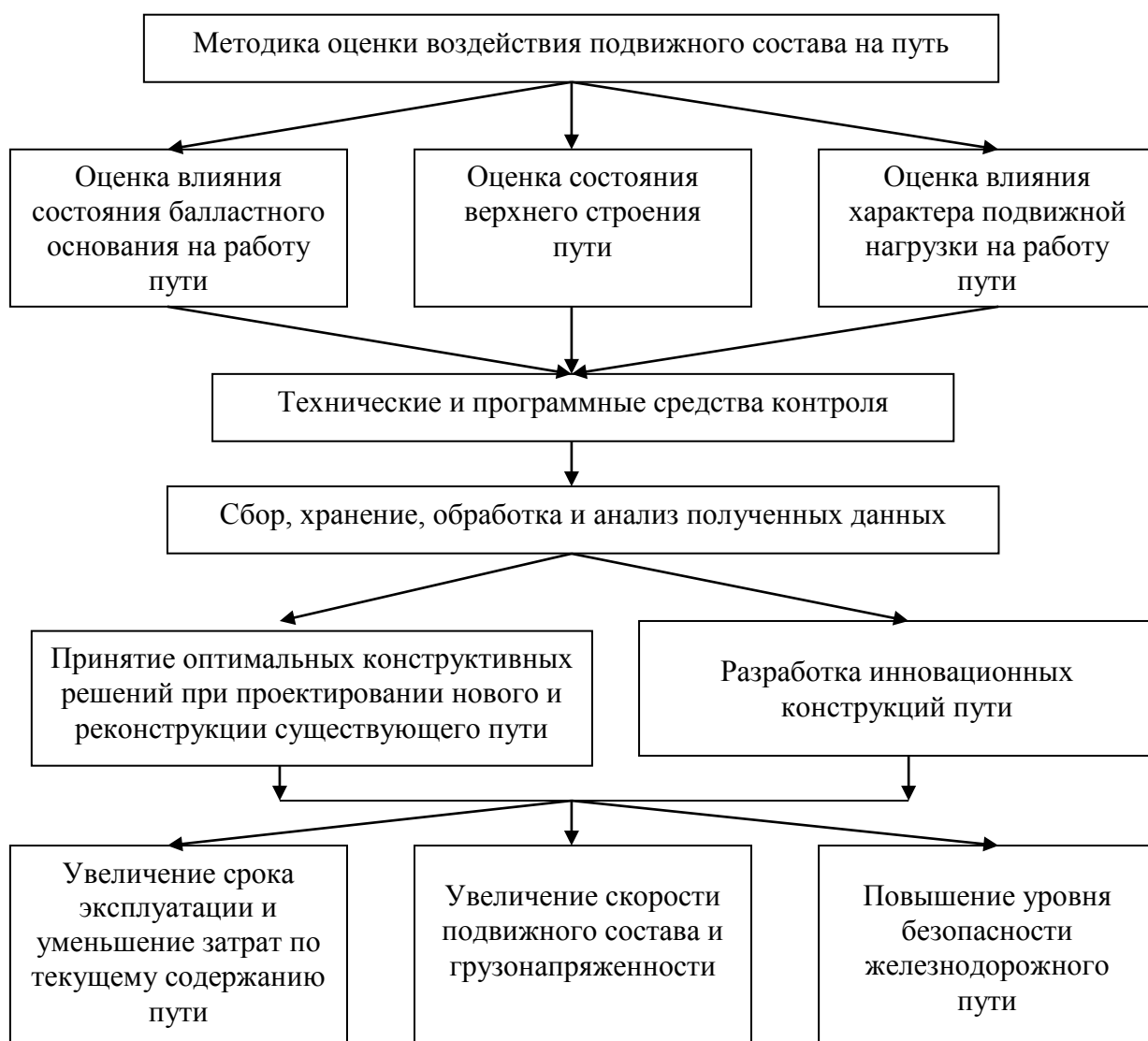
Рисунок 1 – Принципиальная схема методики оценки воздействия экипажа на путь
