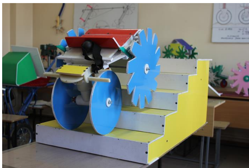
Рисунок 5 – Вид коляски при подъеме по лестнице сзади
