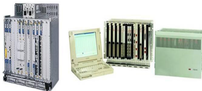
Рисунок 3 – Мультиплексоры NEC U-Node (слева) и ABB FOX 515
