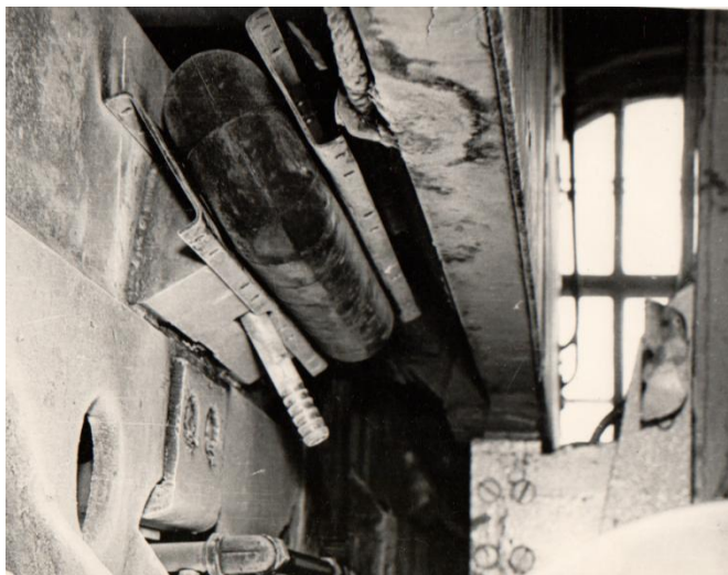
Рисунок 3 – Установка пневмоэлемента НИ-14 на электровозе ВЛ60
